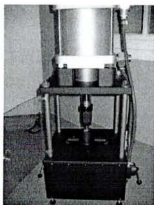
Rys. 4. Ręczna tabletkarka do wytwarzania mas pirotechnicznych
