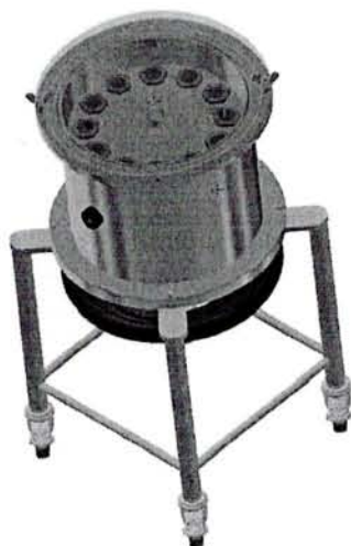
Rys. 32. Wizualizacja komory do inhibitowania ładunków PAC-M
